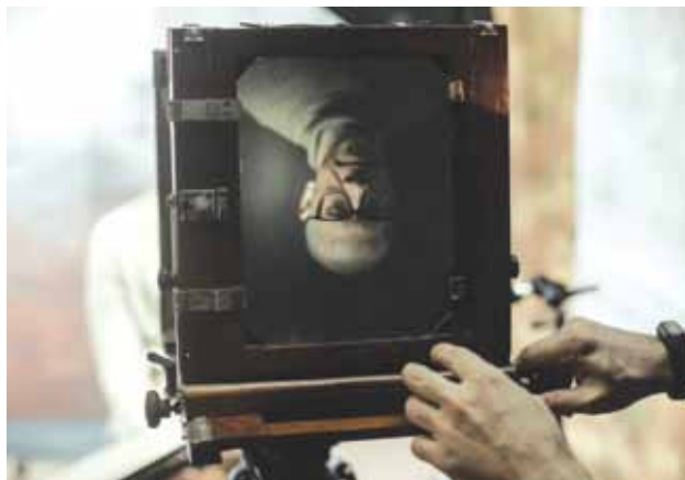
Камера работает как человеческий глаз и переворачивает изображение
