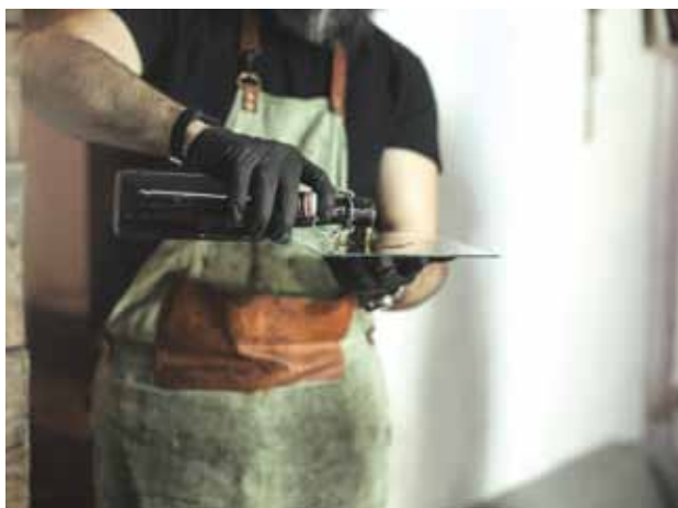
Перед съёмкой стеклянную пластинку нужно полить коллодием, затем она отправится в серебряную ванночку
