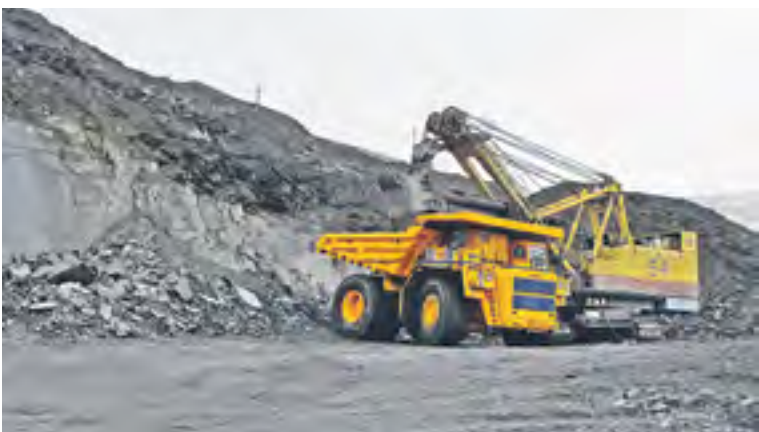
Масштабы работ сегодня впечатляют – идёт погрузка 220-тонного БелАЗа
