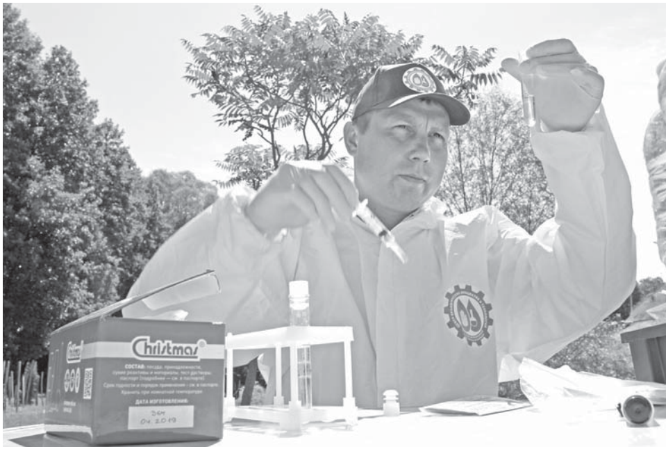
С первым про- вел экспресс- анализ на наличие в воде нитритов — с помощью специального реагента
